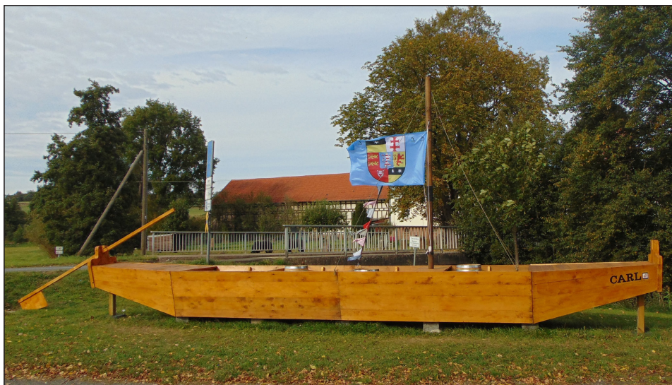
Abb. 7: Nachbau eines „halben Bullen“ in Hatzbach. Lastkähne dieser Art sollten auf dem Landgraf-Karl-Kanal eingesetzt werden (Foto: © E. Erdel)
