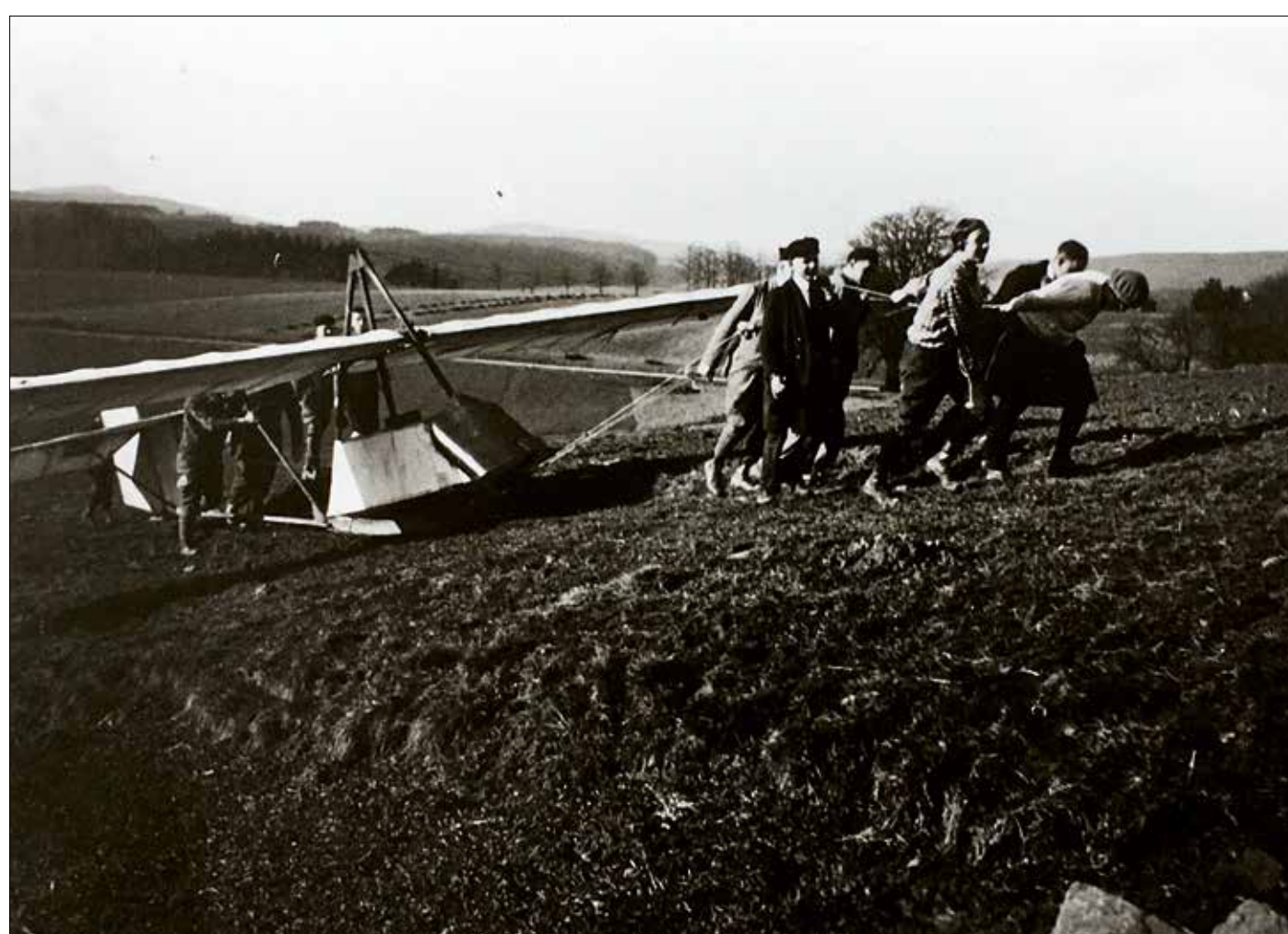
Nach dem Start mit einem Gummiseil und einer im Laufschrift ziehenden Startmannschaft musste der Gleitflieger zum Startplatz am Hasenkopf zurückgebracht werden (vor 1933).
