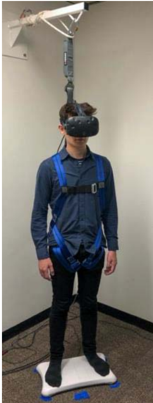
Messungen mit einer Virtual Reality-Brille und einer Kraftmessplatte
